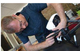
Hervé Ferrand en train d'équiper son drone d'une caméra thermique garantissant la stabilité de l'image. PHOTO DNA - NICOLAS LEHR
